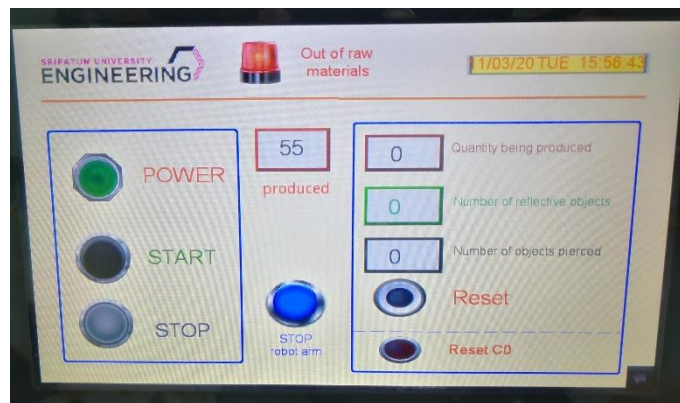
ภาพที่ 6 แสดงจอแสดงผลระบบควบคุม
