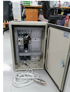
รูปที่ 6 ตู้อุปกรณ์ตรวจจับผงซักฟอกบนรางลำเลียง
