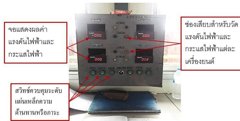
ภาพที่ 2 จอแสดงค่าด้านบนคือค่าของ Shunt Loadหรือค่ากระแสไฟฟ้าและด้านล่างคือค่า (โวลต์V)
