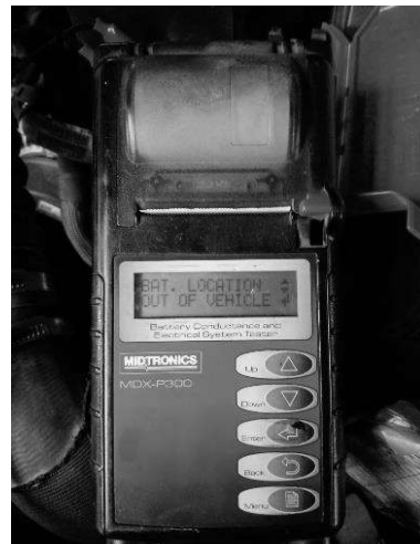
รูปที่ 4 แสดงการระบุขนาดและเลือกรูปแบบการทดสอบแบตเตอรี่
