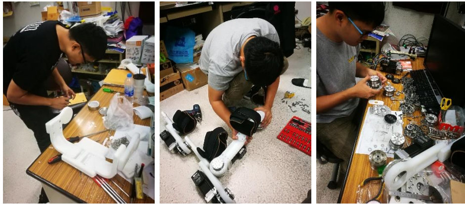
ภาพประกอบ 4.14 ประกอบชิ้นส่วนตามแบบและโครงสร้างหุ่นยนต์พร้อมระบบขับเคลื่อน
