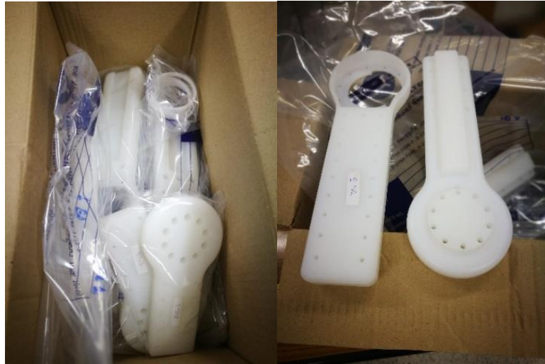
ภาพประกอบ 4.9 ชิ้นงานวัสดุไนลอนสำหรับชิ้นงานยึดติดชุดขับเคลื่อนและโครงยึดหลัก
