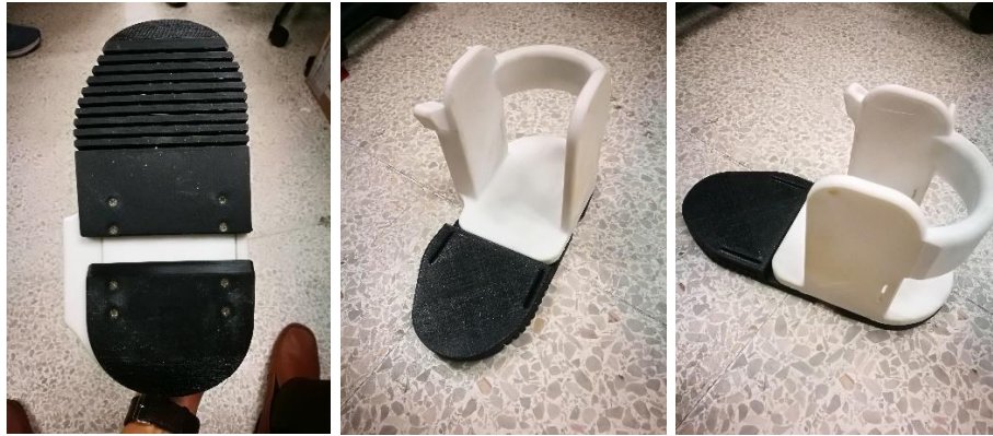
ภาพประกอบ 4.11 ชิ้นงานตามแบบด้วยเครื่องสามมิติ วัสดุเป็น Thermoplastic Elastomer เป็น วัสดุยืดหยุ่นเหมือนยางธรรมชาติ
