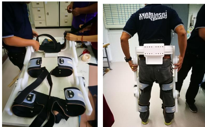
ภาพประกอบ 4.15 ประกอบชิ้นส่วนซอฟต์แวร์รองรับการยึดติดกับร่างกายมนุษย์ ณ สถาบันสิรินธร เพื่อการฟื้นฟูสมรรถภาพทางการแพทย์แห่งชาติ
