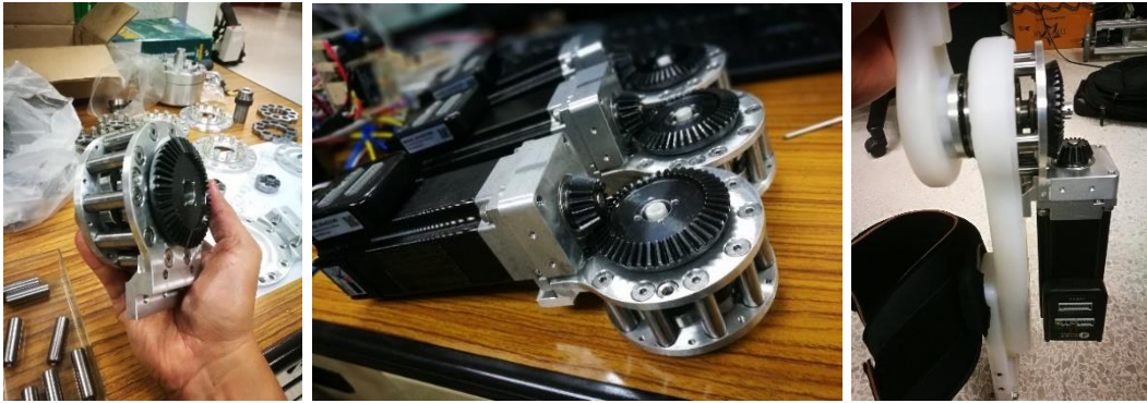
ภาพประกอบ 4.13 ชุดเกียร์ทดกำลังติดตั้งร่วมกับมอเตอร์ระบบขับเคลื่อนหุ่นยนต์ช่วยเดิน
