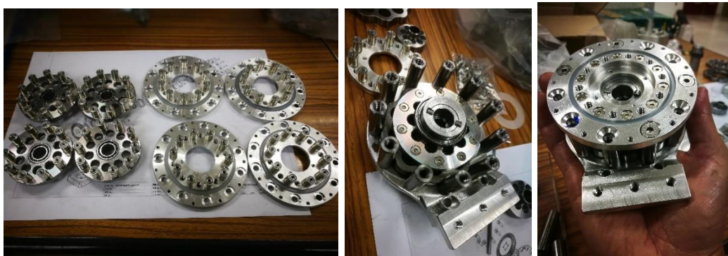
ภาพประกอบ 4.12 ชิ้นส่วนทางกลไกของระบบส่งกำลังของหุ่นยนต์ช่วยเดิน
