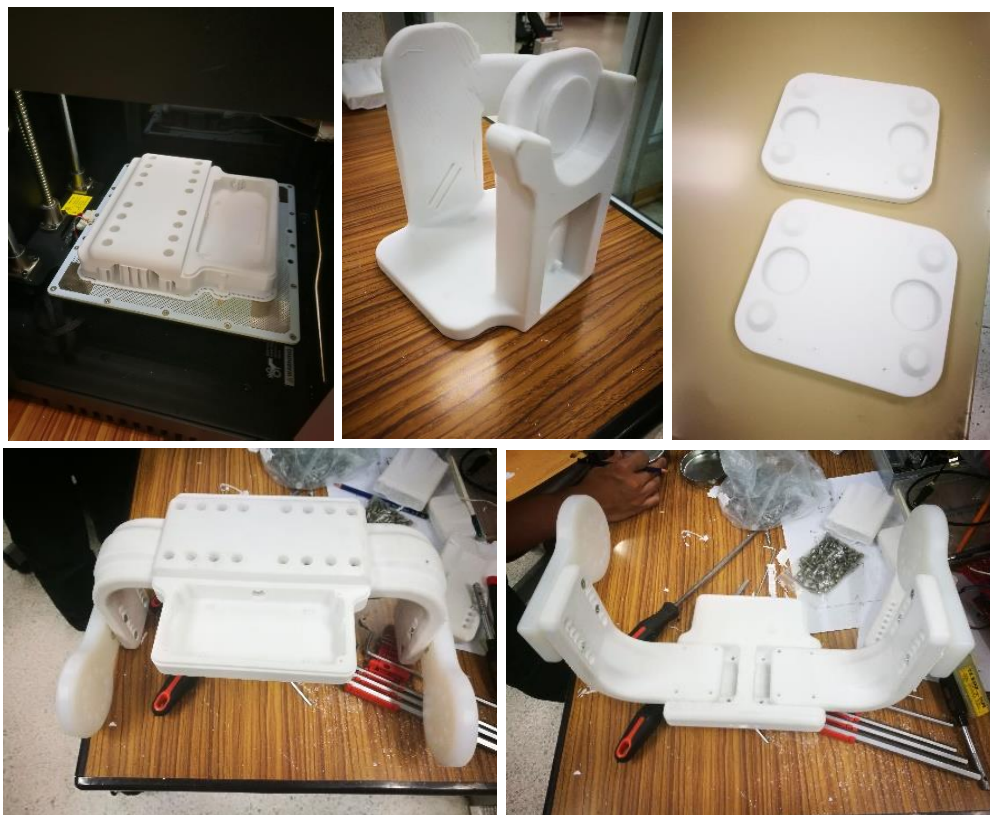
ภาพประกอบ 4.10 ชิ้นงานตามแบบด้วยเครื่อง 3D printer วัสดุโพลีคาร์บอนเนท
