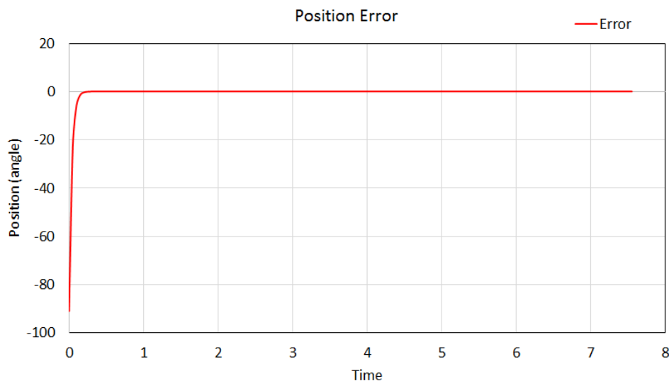
ภาพประกอบ 4.24 แสดงผลลัพธ์ค่าผิดพลาดตำแหน่งด้วยระบบควบคุมพีไอดี K_p=30 , K_i=10 , K_d=2
