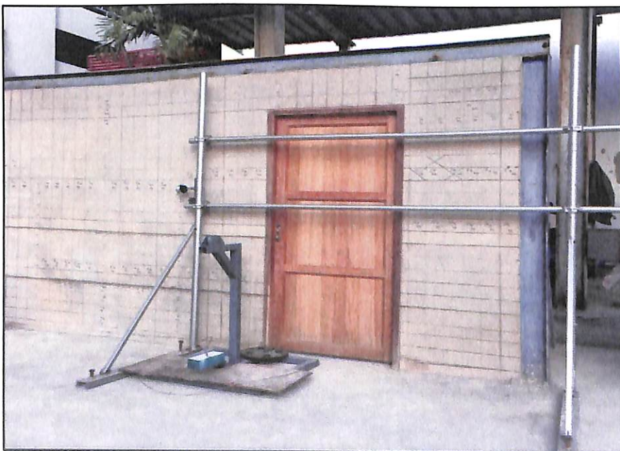
ภาพประกอบที่ 3.12 แสดงการทดสอบแบบ Door Slamming
