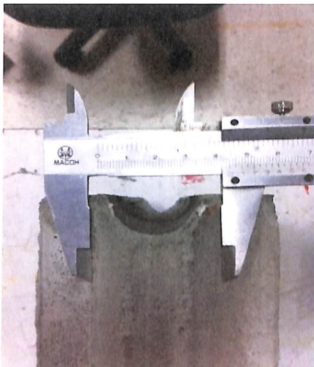
ภาพประกอบที่ ค 5 แสดงการวัดขนาดเดี่ยบลูกส่วนฐาน
