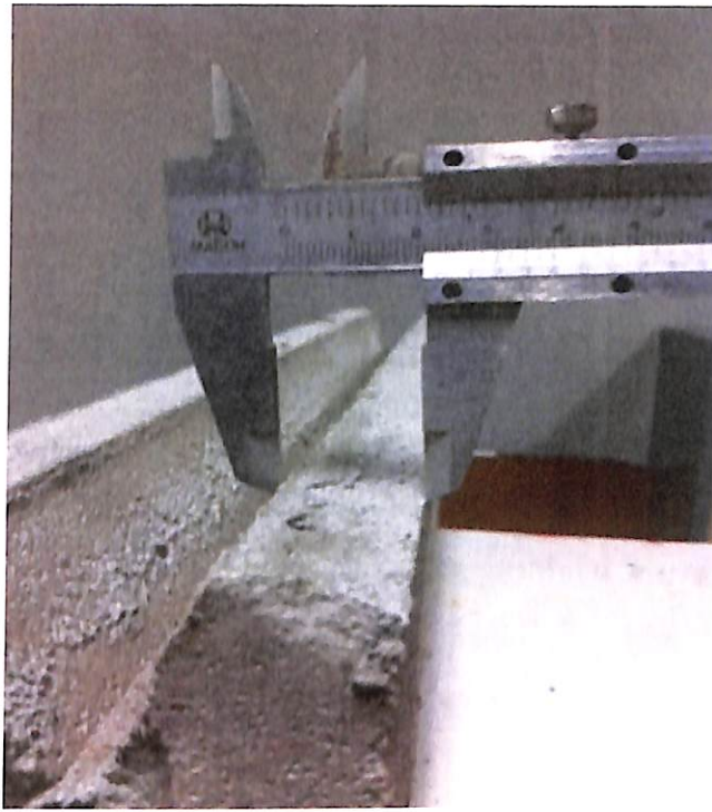
ภาพประกอบที่ 9 แสดงการวัดขนาดร่องด้านบนบนบล็อกด้านขวา
