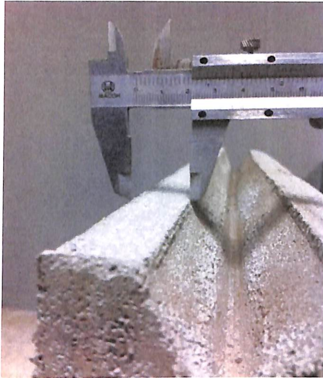
ภาพประกอบที่ ค 7 แสดงการวัดขนาดร่องด้านบนบนบล็อกด้านซ้าย
