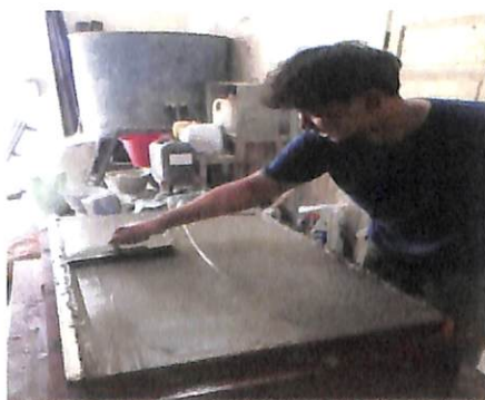
ภาพประกอบที่ 3.25 แสดงการแต่งหน้าส่วนผสม CLC หลังเทลงแบบหล่อ
