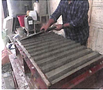
ภาพประกอบที่ 3.28 แสดงการถอดตัวครอบสามเหลี่ยม
