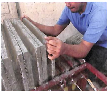
ภาพประกอบที่ 3.32 แสดงการแกะบล็อกออกจากแบบหล่อ
