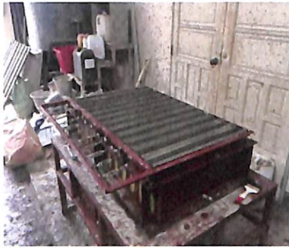
ภาพประกอบที่ 3.29 แสดงการติดตั้งอุปกรณ์สำหรับตัดบล็อก
