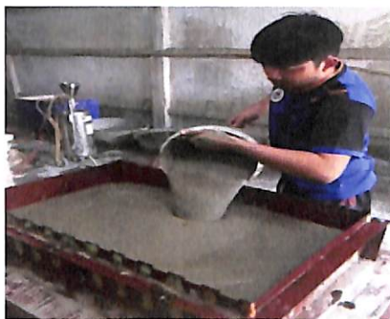
ภาพประกอบที่ 3.24 แสดงการเทส่วนผสม CLC ลงในแบบหล่อ
