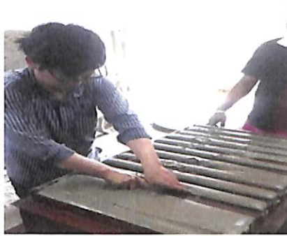
ภาพประกอบที่ 3.26 แสดงการวางตัวกรอบสามเหลี่ยม
