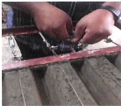
ภาพประกอบที่ 3.30 แสดงการปรับตั้งอุปกรณ์สำหรับตัดบล็อก
