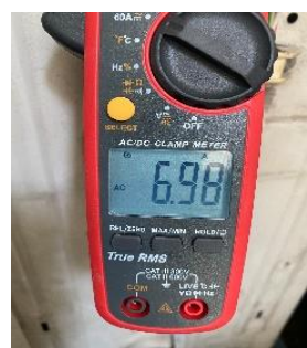
ภาพที่ 5 แสดงถึงการเก็บข้อมูลความเร็วลมและปริมาณการใช้กระแสไฟฟ้า โดยใช้ Anemometer และ Clamp Meter
