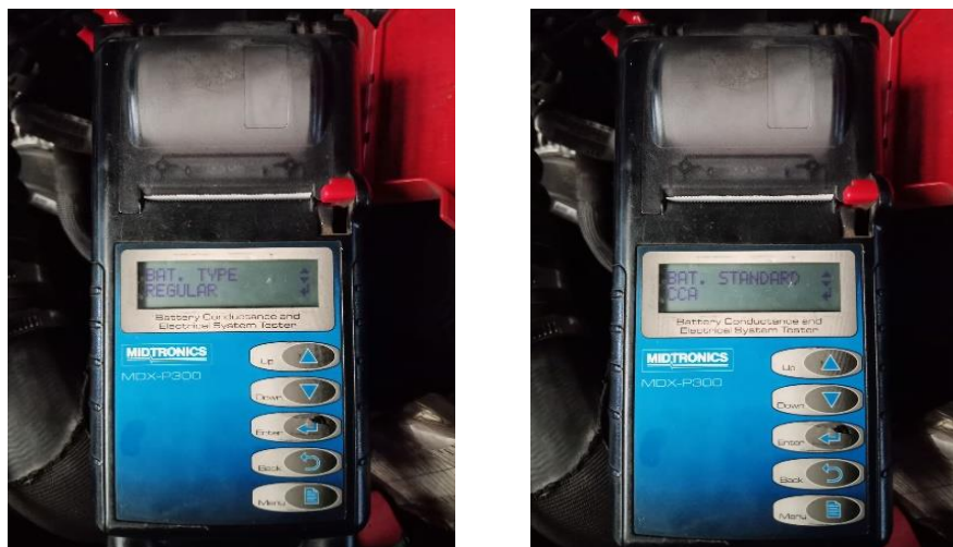
รูปที่ 5 แสดงการเลือกประเภทของแบตเตอรี่และรูปแบบการวิเคราะห์ข้อมูล
