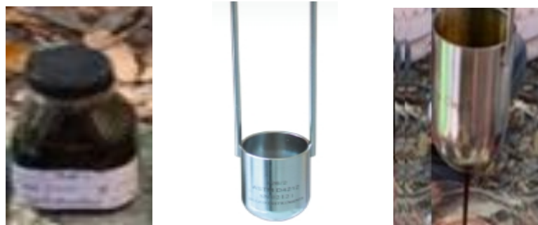
รูปที่ 6 แสดงตัวอย่างข้อมูล ถ้วยวัดความหนืด Zahn Cup และวิธีการวัดค่าความหนืด
