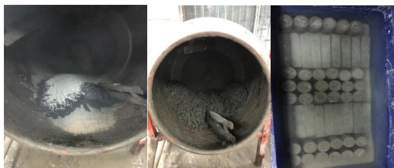
ภาพที่ 5 ขั้นตอนการเตรียมตัวอย่างคอนกรีตที่มีส่วนผสมของเปลือกไข่ไก่เผา ถั่วแกลบและ HDPE
