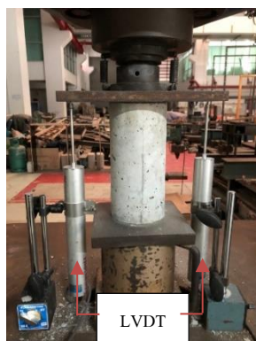
ภาพที่ 6 การทดสอบกำลังรับแรงอัดของคอนกรีต
