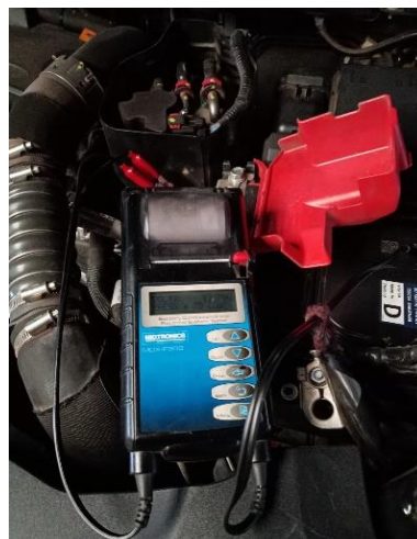
รูปที่ 3 แสดงการเชื่อมต่อขั้วแบตเตอรี่กับเครื่องมือวัด
