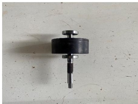
ภาพที่ 4 แสดงถึงส่วนที่เคลื่อนที่หรือ โรเตอร์ (Rotor) และ สเตเตอร์ (Stator)
