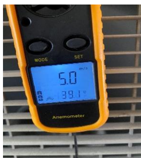
ภาพที่ 5 แสดงถึงการเก็บข้อมูลความเร็วลมและปริมาณการใช้กระแสไฟฟ้า โดยใช้ Anemometer และ Clamp Meter
