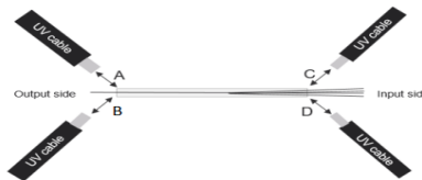
รูปที่ 4 ตำแหน่งของเครื่องอบกาวที่เล็งไปที่กาวจากมุมมองด้านบน
