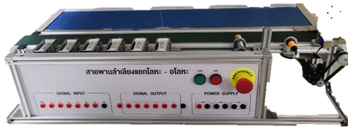
ภาพที่ 5 สายพานลำเลียงคัดแยกโลหะและอโลหะ
