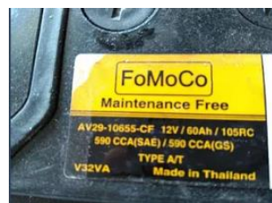
รูปที่ 1 แสดงตัวอย่างของ โฟโมโคแบตเตอรี่และส่วนประกอบหลักของแบตเตอรี่รถยนต์
