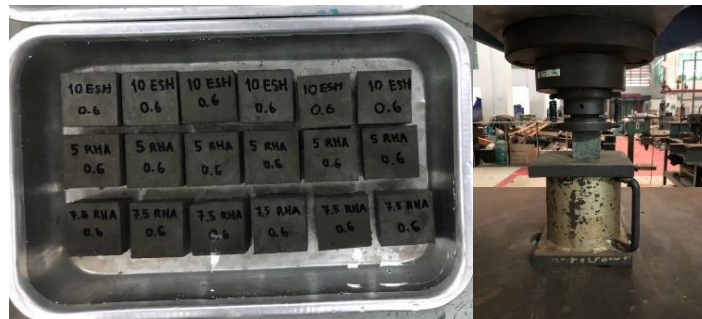
ภาพที่ 4 ตัวอย่างและการทดสอบกำลังรับแรงอัดของมอร์ตาร์
