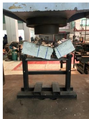
ภาพที่ 7 การทดสอบกำลังรับแรงดัดของคอนกรีต
