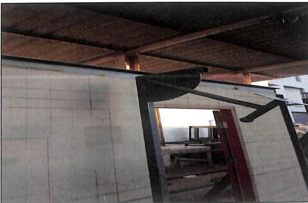
ภาพประกอบที่ ค.18 เปิดองศาเหวี่ยงลูกตุ้มเหล็กหนัก 3 กิโลกรัม ให้กระทบผนังที่แก้ไขรอยแตกร้าว
