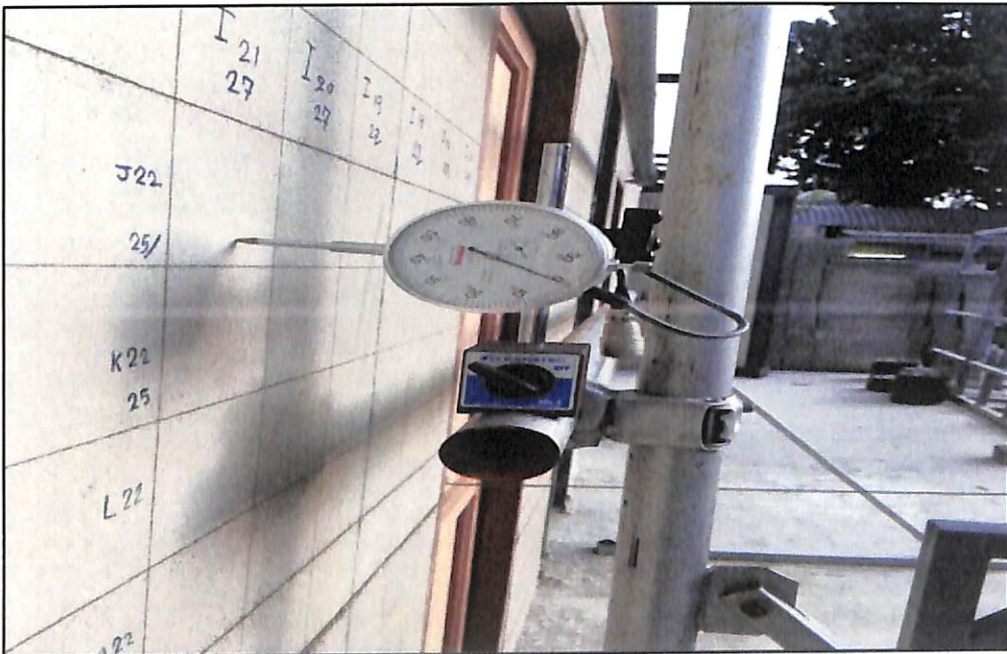
ภาพประกอบที่ ข.2 ปรับค่า Dial Gauge ให้อยู่ตำแหน่งศูนย์
