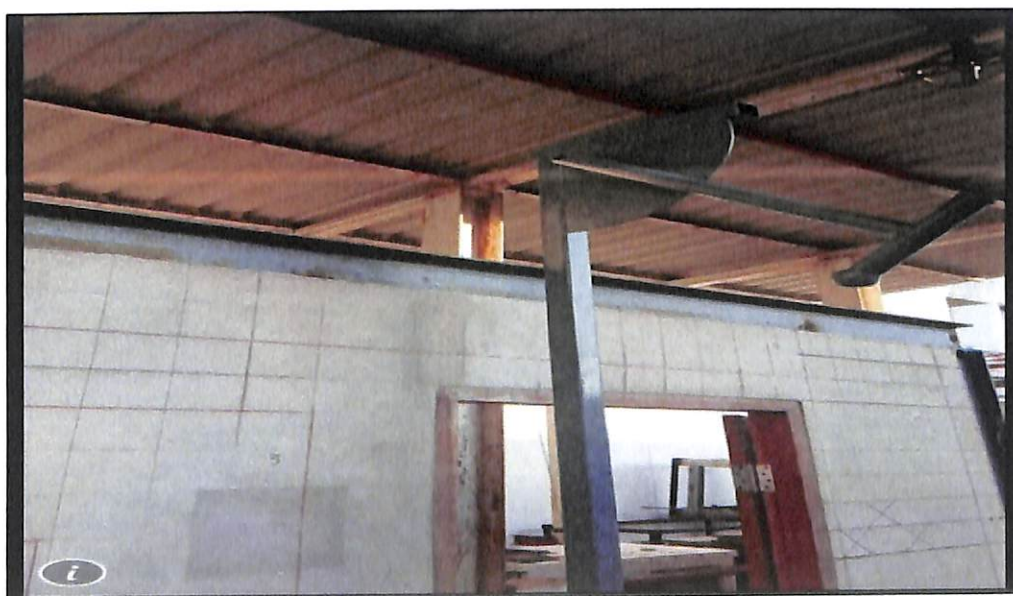
ภาพประกอบที่ ค.6 เปิดองศาหีงลูกตุ้มเหล็กหนัก 3 กิโลกรัม ให้กระทบผนังที่แก้ไขรอยแตกร้าว
