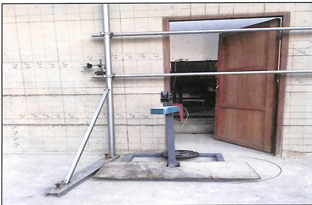
ภาพประกอบที่ ข.3 เปิดบานประตูให้ได้ 60 องศาและปล่อยให้กระแทกวงกบ รอบแรกจำนวน 20 ครั้ง
