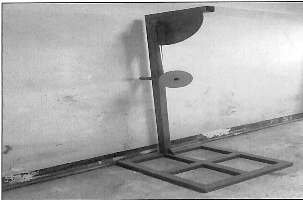
ภาพประกอบที่ ค.1 เครื่องใช้ทดสอบ Small Hard Body Impact
