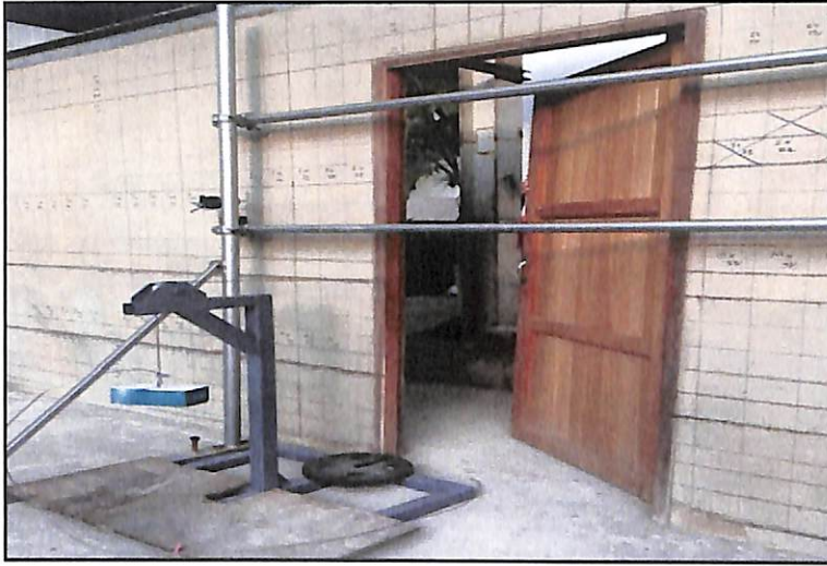
ภาพประกอบที่ 3.14 ผนังที่ทำการทดสอบการเก็บข้อมูลการแตกร้าว
