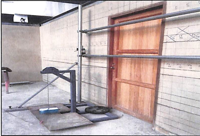
ภาพประกอบที่ 3.15 การเก็บข้อมูลการแตกร้าวของผนังขนาด 9 เซนติเมตร
