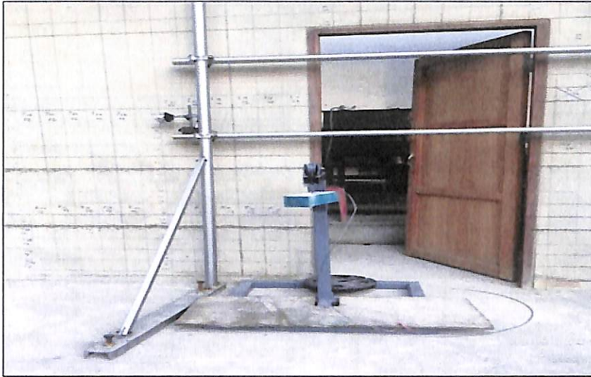
ภาพประกอบที่ 4.3 แสดงการทดสอบแบบ Door slamming
