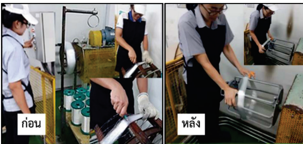
รูปที่ 5 (a) รูปก่อน , (b) รูปหลังการปรับปรุง ในการนำด้ายออกจากวงล้อของเครื่องลอกด้าย
