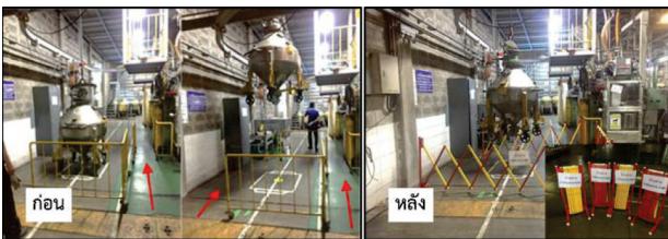
รูปที่ 4 (a) รูปก่อน , (b) รูปหลังการปรับปรุง การวางแนวกั้นและติดป้ายห้าม
