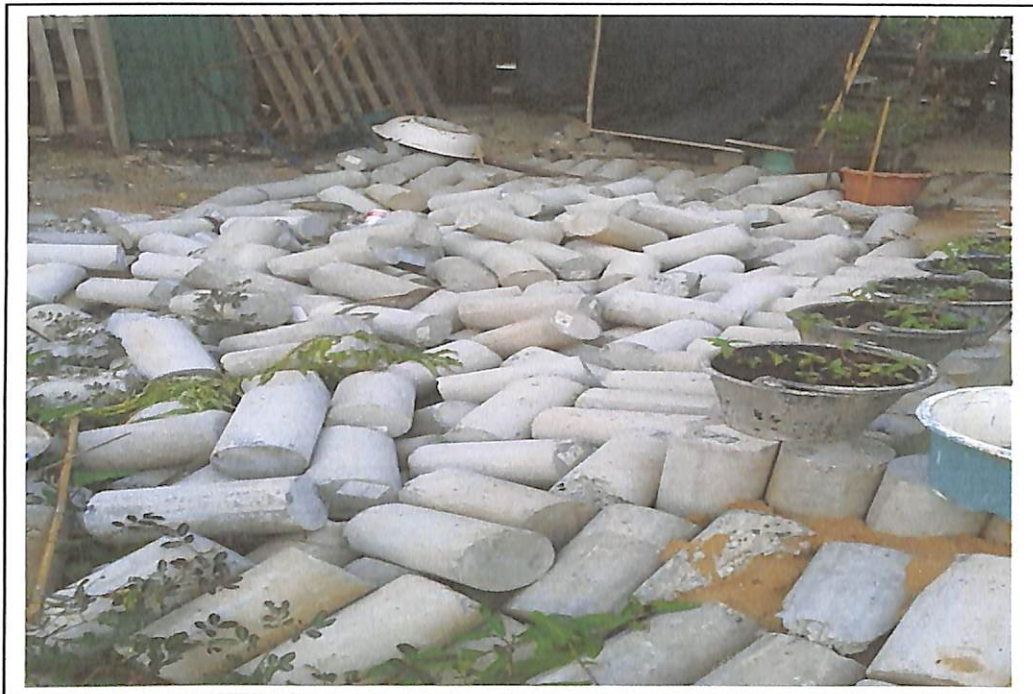
ภาพประกอบที่ 3 แท่งทดสอบคอนกรีตที่เหลือทิ้งจากการทดสอบ
