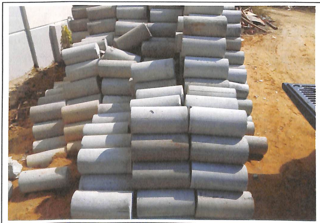
ภาพประกอบที่ 4 แท่งทดสอบคอนกรีตที่เหลือทิ้งจากการทดสอบ
