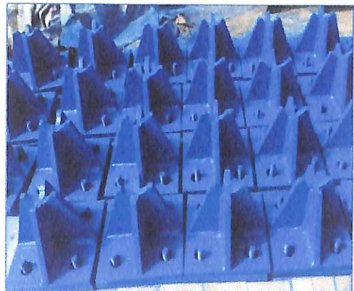
ภาพประกอบที่ 2.10 แบบแสดงชิ้นส่วนที่เป็น (Support Plate ใน Space Rigid Frame) ที่มา : บริษัท พรี่มา โกลบอลลิงค์ จำกัด
