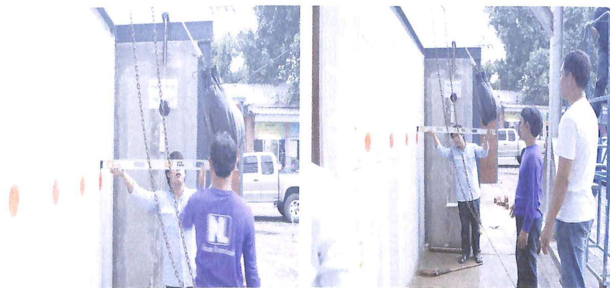
ภาพประกอบที่ 4.2 การทดสอบผนังเมอร์อาอินฟิวลัด แบบ Large Soft Body Impact
