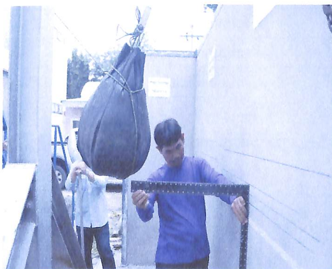
ภาพประกอบที่ 4.5 การทดสอบผนังก่ออิฐมวลเบาแบบ Large Soft Body Impact
