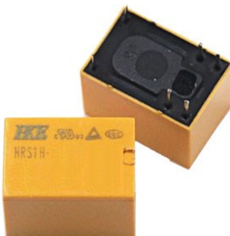
รูปที่ 14 รีเลย์ HRS4H-S-Dc12V [ที่มา www.es.co.th ]
