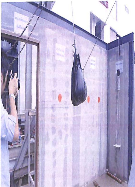
ภาพประกอบที่ 4.2 การทดสอบผนังเมอร์อาอินฟิวลวด์ แบบ Large Soft Body Impact
