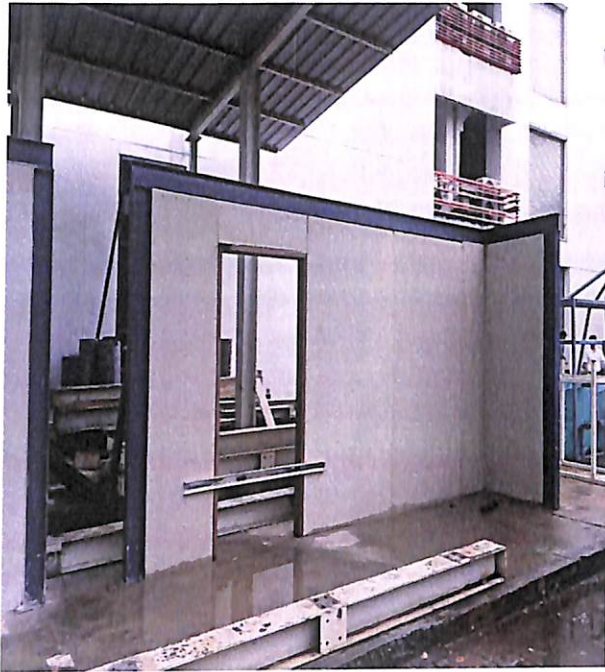
ภาพประกอบที่ 4.1 ผนังทดสอบระบบผนังหล่ออินฟิวลวด์
