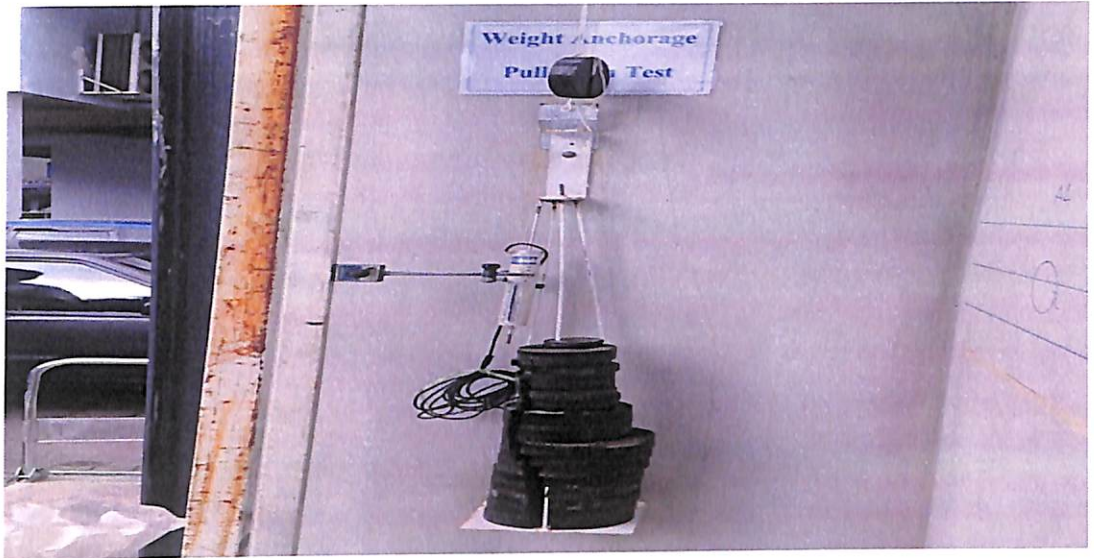
ภาพประกอบที่ 4.7 การทดสอบผนังก่ออิฐมวลเบา แบบ Pull-down Test
