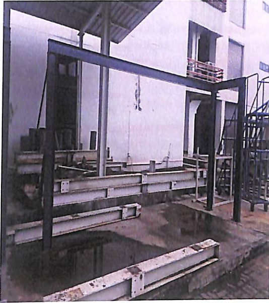
ภาพประกอบที่ 4.4 ผนังทดสอบระบบผนังก่ออิฐมวลเบา
