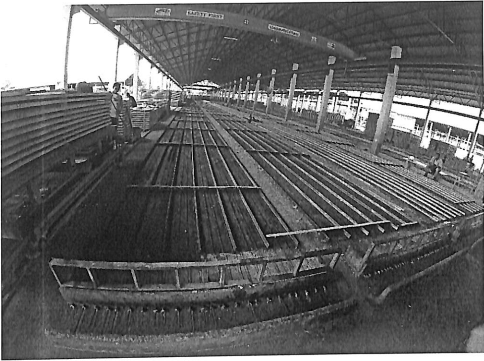
ภาพแสดงแท่นผลิตแผ่นพื้นสำเร็จรูปท้องเรียบ
