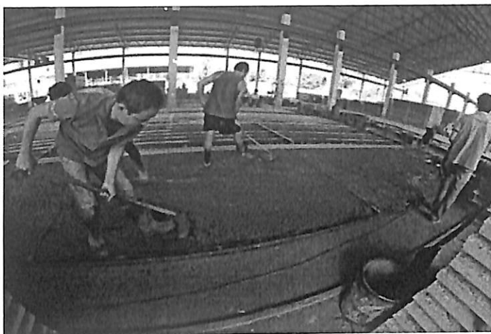
ภาพประกอบที่ 3.4 แสดงการเกลี่ยปูนให้เต็มแทนผลิต
