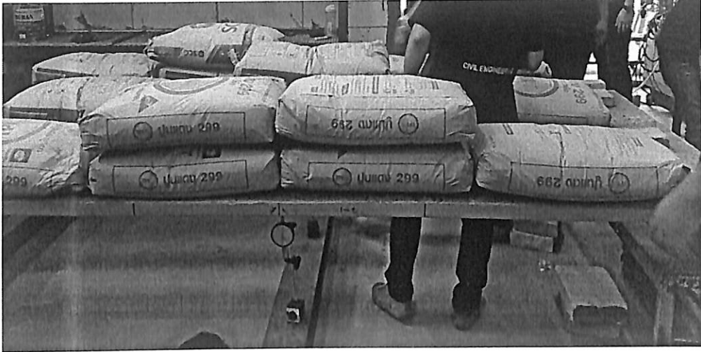
ภาพประกอบที่ 3.6 แสดงการทดสอบน้ำหนักบรรทุกทุกแบบแผ่นเฉื่อยสม่ำเสมอ
