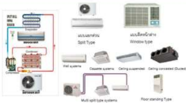
ระบบปรับอากาศแบบแยกส่วน (Split Type Air Conditioner)
