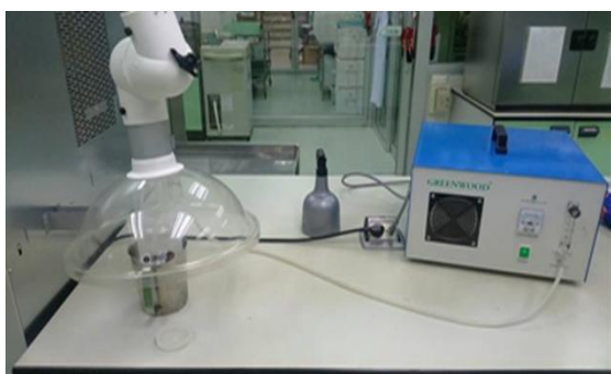
ภาพที่ 3 การทดสอบใช้โอโซนฆ่าเชื้อจุลินทรีย์ตามระยะเวลาที่กำหนด
