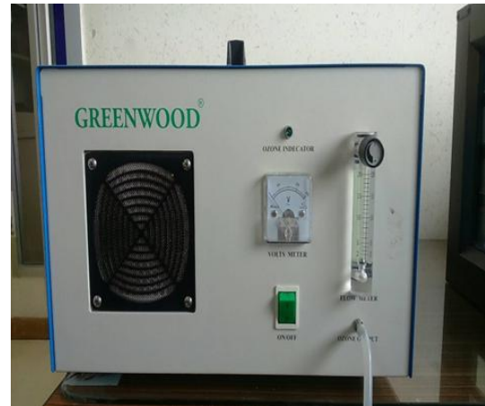
ภาพที่ 1 แสดงเครื่องผลิตแก๊สโอโซน 2,000 มิลลิกรัมโอโซน/ชั่วโมง
