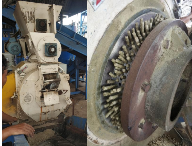
ภาพที่ 2 แสดงการผลิตชีวมวลอัดเม็ดจากหญ้าเนเปียร์พันธุ์เขียวสยาม
