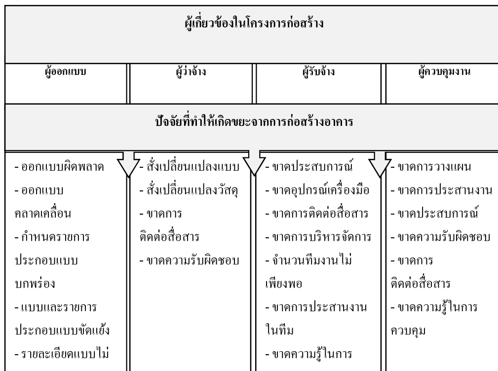
ภาพที่ 3 สาเหตุการเกิดขยะในโครงการก่อสร้างจำแนกตามกลุ่มผู้เกี่ยวข้อง ที่มา: จากการสัมภาษณ์ผู้เชี่ยวชาญ
