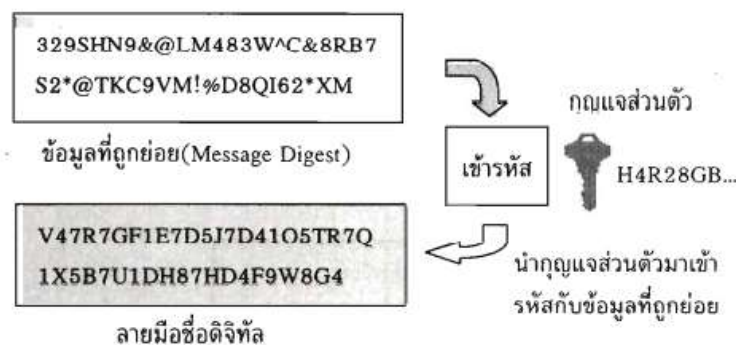
ภาพประกอบที่ 2.5 ภาพแสดงขั้นตอนการสร้างลายมือชื่อดิจิทัล 14
