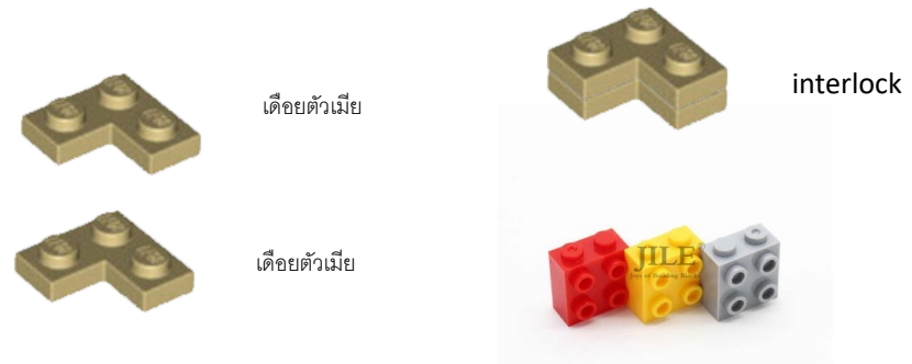
รูปแสดง ภาพที่12 การเข้ามุมของตัวต่อเลโก้เพื่อเพิ่มความแข็งแรงและคงทน
