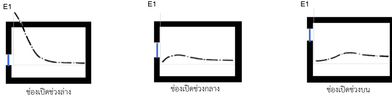
ภาพที่ 2.13 แสดงลักษณะการเปรียบเทียบปริมาณของค่าความสว่างภายในจากช่องเปิดแบบต่าง ๆ สืบค้นจาก : Majoros, 1988, p. 38
