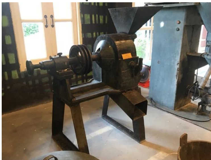
รูปที่ 24 เครื่องบดแร่ ใช้บดหินที่มีคาบแร่ติดอยู่กับแร่
