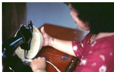
ภาพที่ 2.7 การเย็บเส้นเปียให้ต่อเนื่อง
