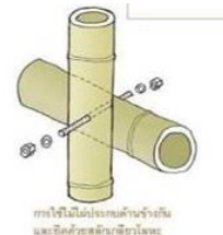
การใช้ไม้ไผ่ประกบด้านเข้ากัน และยึดด้วยสลักเกลียวโลหะ
