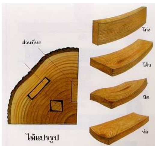
รูปที่ 15 การเสียรูปจากการหดตัว ที่มา : http://kanchanapisek.or.th
