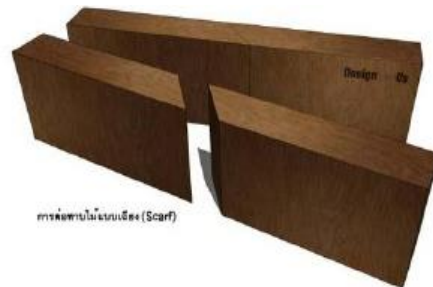
รูปที่ 22 การต่อทาบแบบเฉียง ที่มา : https://www.scribd.com
