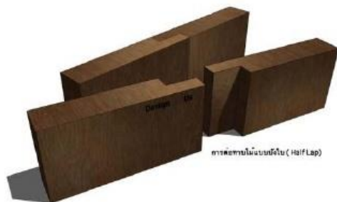
รูปที่ 21 การต่อทาบแบบบังไม้ ที่มา : https://www.scribd.com
