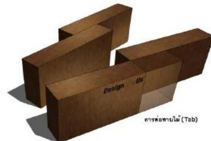
รูปที่ 24 การต่อทาบแบบ ล็อคประสาน ที่มา : https://www.scribd.com
