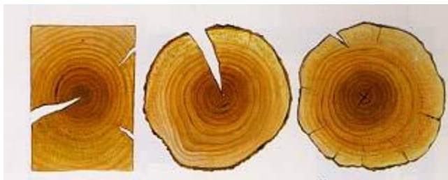
รูปที่ 16 การเสียรูปจากการหดตัว ที่มา : http://kanchanapisek.or.th
