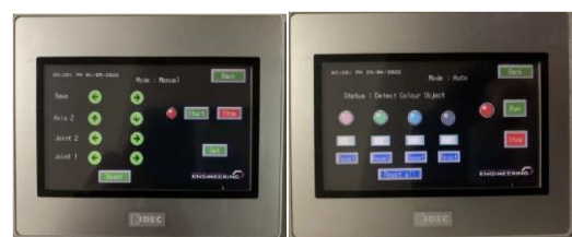
รูปที่ 4 หน้าจอ HMI สำหรับโหมดแบบ Manual Mode และ Automatic Mode
