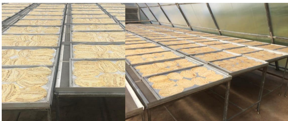
ภาพประกอบที่ 20 การทดลองแปรรูปกล้วยโดยใช้โรงอบแห้งพลังงานแสงอาทิตย์ร่วมกับระบบอบแห้งแบบลมร้อน
