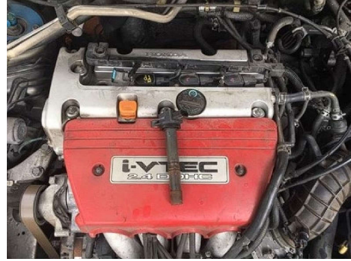
รูปที่ 4 การจำลองให้เครื่องยนต์ทำงานไม่ครบสูบ
