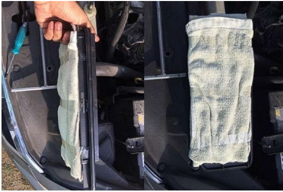
รูปที่ 3 การจำลองให้กรองอากาศเกิดการอุดตัน
