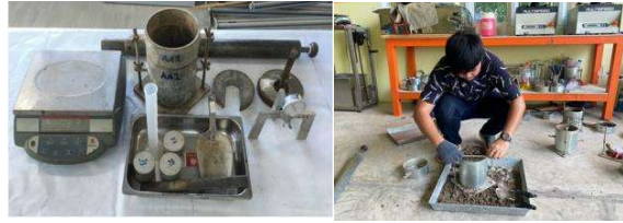
รูปที่ 5 การทดสอบการทดสอบกำลังของดินบดอัดวิธีแคลิฟอร์เนีย แบบรีจเรโซ
