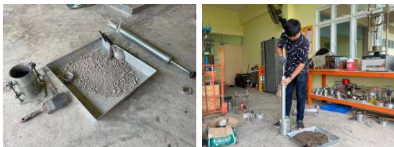
รูปที่ 4 การทดสอบการบดอัดดิน
