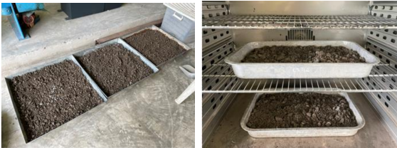
รูปที่ 2 การผึ่งและการอบดินชั้นพื้นทาง
