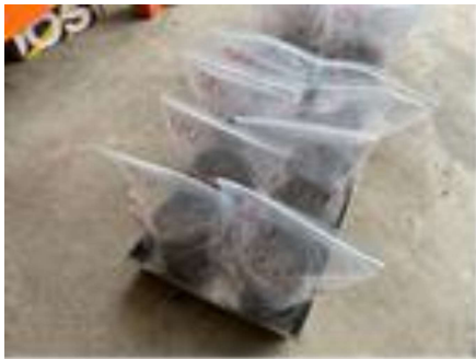
รูปที่ 8 การนำมวลรวมตัวอย่างบ่มก่อนทดสอบ 7 วัน
