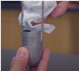
รูปที่1 แสดงถ้วยวัดความหนืด Zahn Cup และวิธีการวัดค่าความหนืด
