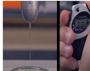
รูปที่1 แสดงถ้วยวัดความหนืด Zahn Cup และวิธีการวัดค่าความหนืด
