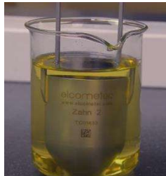
รูปที่1 แสดงถ้วยวัดความหนืด Zahn Cup และวิธีการวัดค่าความหนืด
