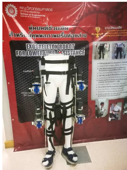
รูปที่ 1.7 ต้นแบบหุ่นยนต์ช่วยเดินสำหรับผู้ทุพพลภาพครึ่งท่อนล่าง
