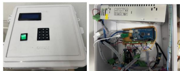
รูปที่ 5 กล่องควบคุมและชุดสมอกลฝั่งตัวด้วยไมโครคอนโทรลเลอร์
