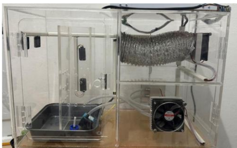
รูปที่ 3 ชุดต้นแบบเพาะปลูกต้นอ่อนพืชสำหรับควบคุมอุณหภูมิและความชื้นสัมพัทธ์
