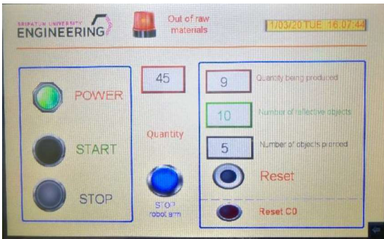
รูปที่ 4 หน้าจอจำลองควบคุมการทำงาน สายพานลำเลียง
