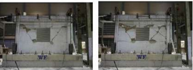
รูปที่ 4 การวิบัติของโครงผนังก่อแบบช่องเปิดหน้าต่าง (WF)
