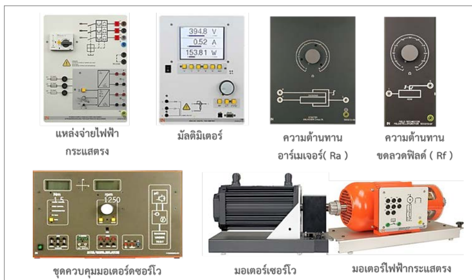
ภาพที่ 3 อุปกรณ์ที่ใช้สำหรับการจำลองการทำงานของมอเตอร์ไฟฟ้ากระแสตรง
