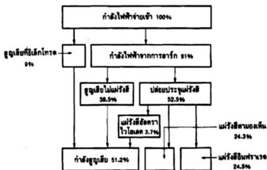
ภาพที่ 2.4 แสดงการกระจายพลังงานของหลอดโซเดียมแรงดันสูง
